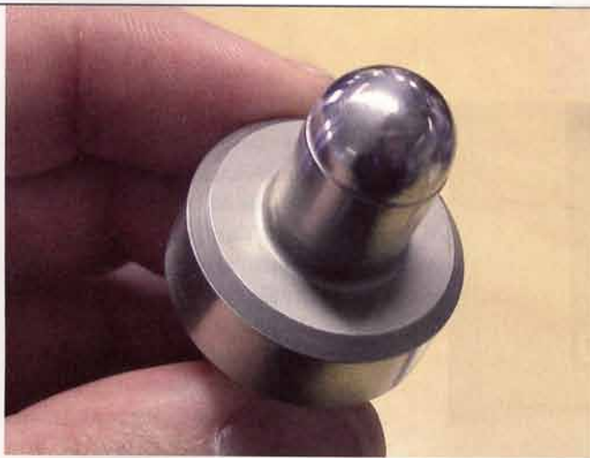
2 Rundschleifen nahezu ohne Grenzen: Typische LRT-Bauteile vereinen knifflige Anforderungen in sich; das Bild links zeigt eine Messauflage aus einem hochlegierten Kaltarbeitsstahl mit exakt vorgegebener Kugelform und Höhe über Bund sowie einem Mittenrauwert R_a kleiner 1 \mu\text{m} , das Bild rechts eine Umlenkbuchse für ein Spritzgusswerkzeug mit einer hochgenauen Kegelverbindung
