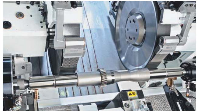
Bearbeitung Getriebewellen parallel mit zwei Schleifscheiben.
