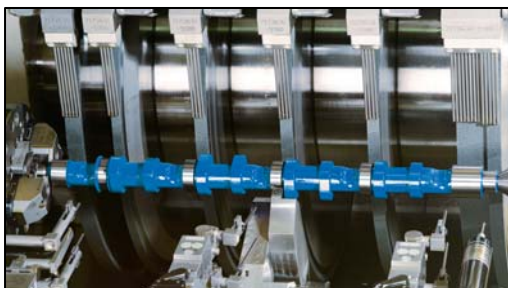
Schleifstation 1: Schleifen der Lager- und Zapfendurchmesser
